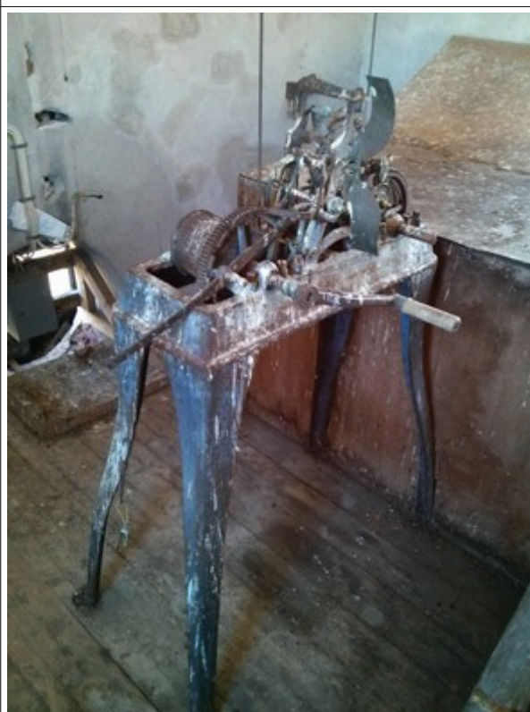
Det gamla urverket i klocktornet på Kiörningskolan är numera urkopplat och nersölat med duvspillning.
