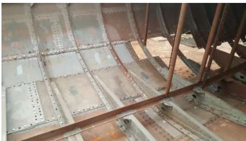
1Plate C babord side spt 21 ½ 24 ½ i lasterom montert før avreise 16.6.16. Klinking og dikking gjenstår. Foto: G.J/Randsfjordmuseene
