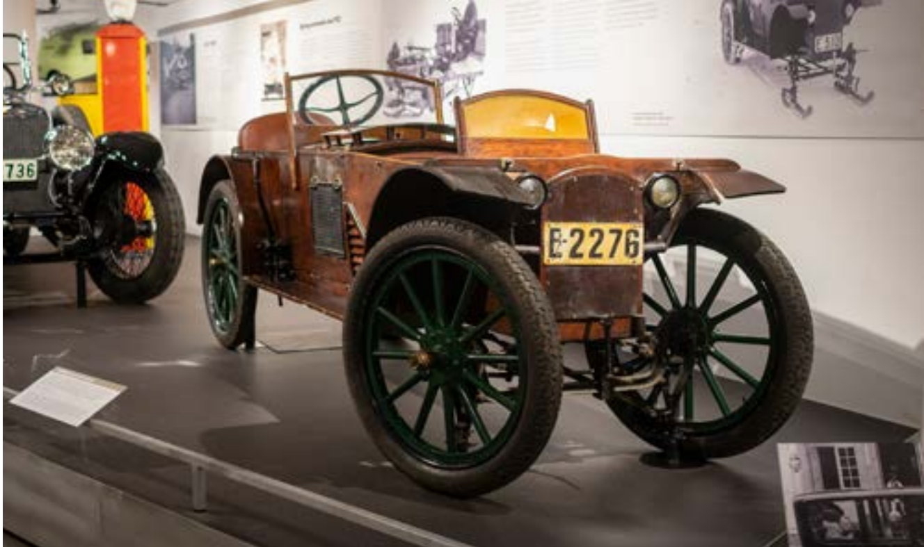
I 1921 laget Hans Christian Bjering på Gjøvik den første av seks biler bygd for smale norske vinterveier. Fire ble bygd med trekarosseri og senere ble det bygd to til i aluminium. (Foto: Morten Reiten)
