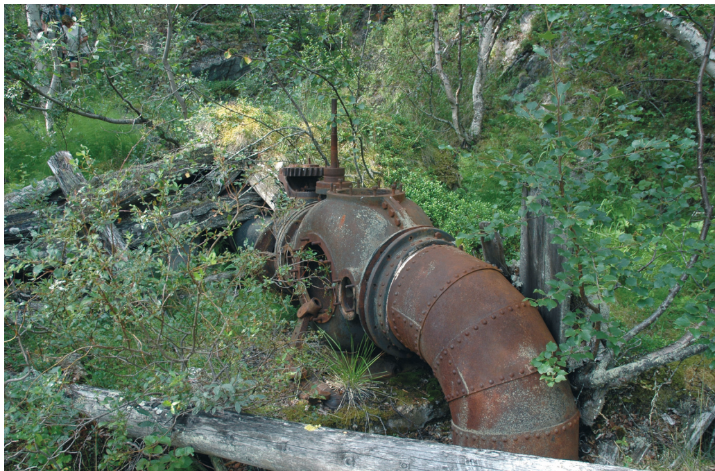
Restene av turbinen ved kraftanlegget i Vangrøfta. Foto: Jon Holm Lillegjelten.
