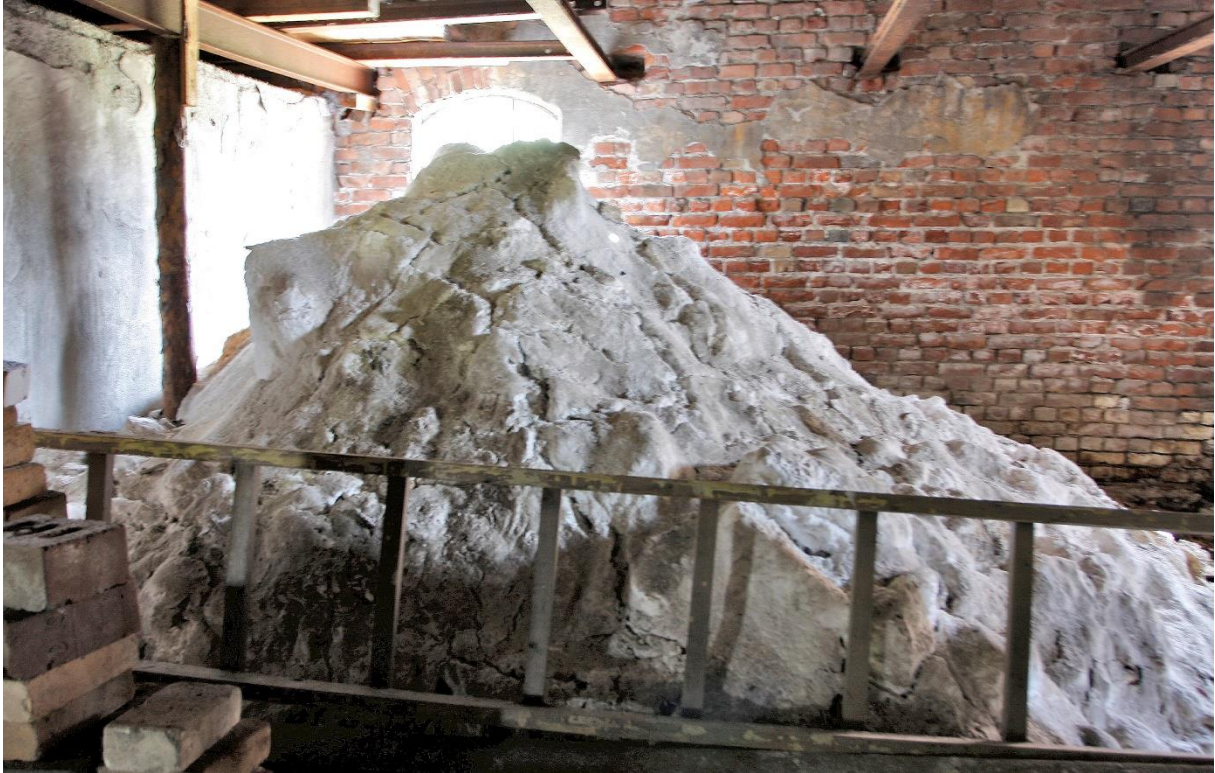
Figur 27: Haugen med natriumsulfat som ble brukt til lutgjenvinning i sodaovnene. Haugen lå i det nordøstre hjørnet av Sodahuset, nær sodaovnene. Den var på ca. 5 tonn og lå på svært fuktig grunn, slik at salter herfra ble spredt i omgivelsene. Haugen ble først fjernet i 2017, sammen med flere andre masser inne i fabrikk. Fortsatt ligger det ca. 180 tonn med saltinfiltrerte masser igjen i fabrikk, de skal med det første fjernes, slik det beskrives i hovedrapporten fra Kunnskapsprosjektet. Foto: Riksantikvarens arkiv.
