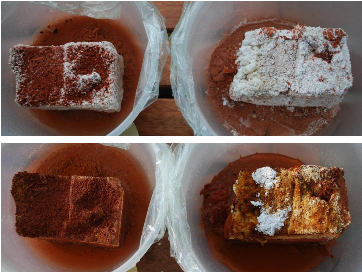
Figur 116: Saltkrystallisasjonsforsøket. Tegl med magnesiumklorid til venstre. På det øvre bildet har saltene krystallisert og skapt mer skade på den ikke-behandlede steinen. På bildet under er deler av steinene i ferd med å tørke opp etter at vann har blitt tilført karene. Vi ser at det tørker raskere opp i karet med den ubehandlede steinen. En viktig observasjon etter ett år er også at saltene på den ubehandlede steinen ikke helt forsvinner etter at vann er tilført, også i svært fuktig høstklima.
