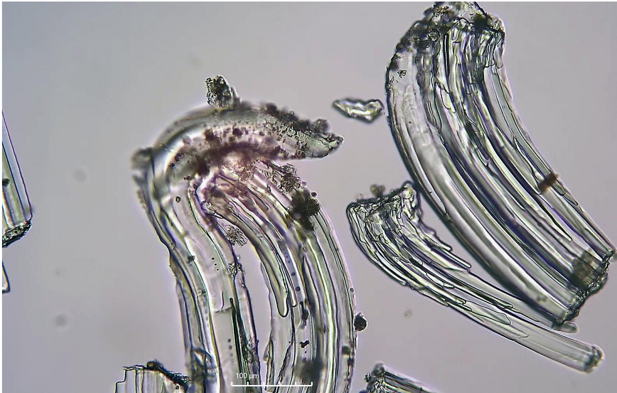
Figur 77: Whiskerkrystaller av halitt ( \text{NaCl} ) funnet på vegger behandlet med kalsium- og magnesiumklorid i Motorhuset. Sett i polarisasjonsmikroskop, enkeltpolarisert lys.
