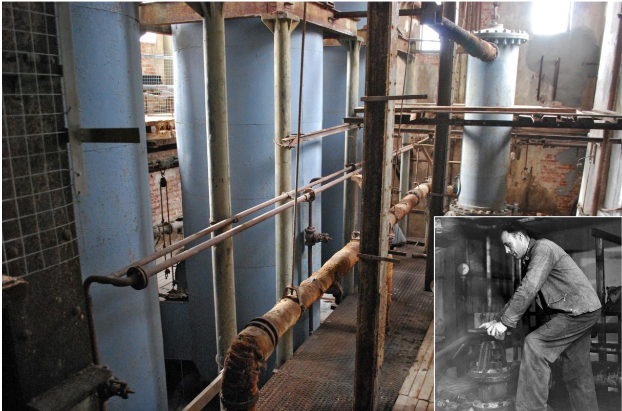
Figur 55: Kokeriet sett mot vest med de tre cellulosekokerne og varmeveksler til høyre. Innfelt: Koker Jens Fossen på toppen av en av cellulosekokerne, trolig ca. 1960. Herfra ble kokerne matet med treflis og hvitlut. Foto: Anno Museum.
