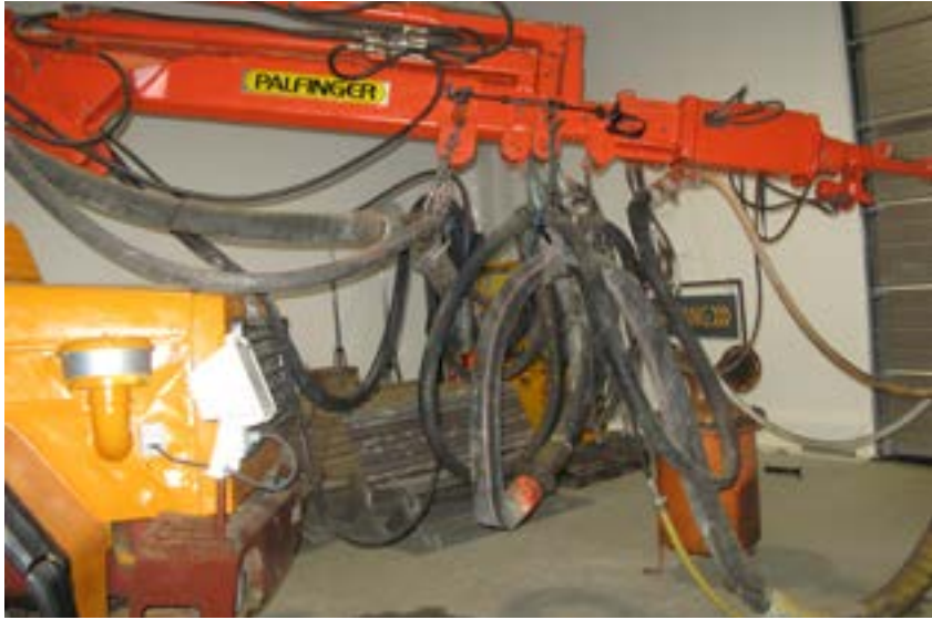
Sprøyterigg for sprøyting av betong – prototype bygget av en ombygd lastebil i regi av Robocon i 1986. Denne befinner seg på Norsk vegmuseum. (Foto: ukjent, fra Norsk vegmuseums fotoarkiv)
