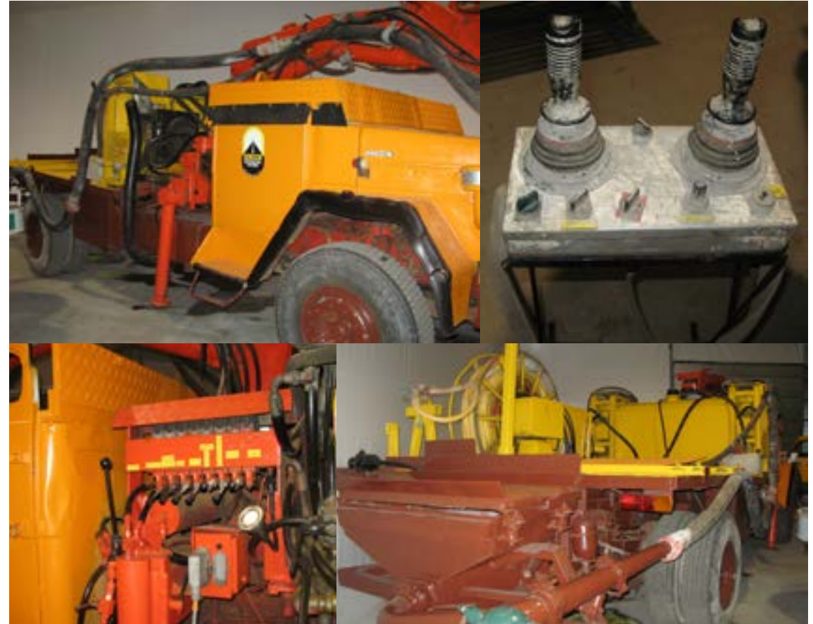
To varianter av tidlig utstyr for sprøyting av betong. (Foto: ukjent, fra Norsk vegmuseums fotoarkiv)
