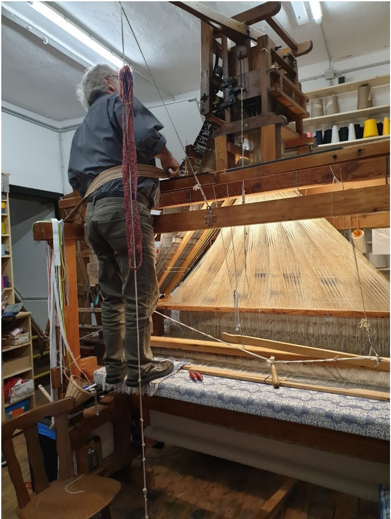
Figur 7 Herman Wendlinger monterer hullkort på toppen av Jacquardveven. Foto: Camilla Rossing, NBF.
