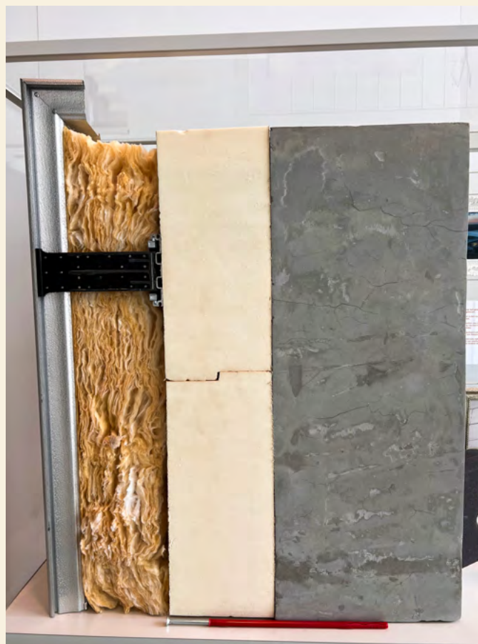
Tverrsnitt av veggjen på CCNL. Frå venstre: aluminiumsplate, to lag isolasjon, betong. Totalt 60 cm
