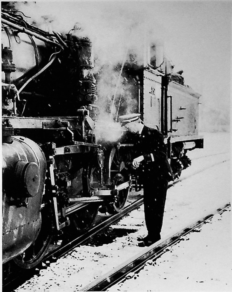
Lokfører Jørgensen går over gangtøyet med smørekanne og skiftenøkkel under vannfyllingen på Kongsberg. Foto: R. Gaskell.
