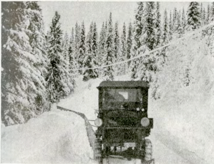
Fig. 9. Kant-rømning med sideplog.
