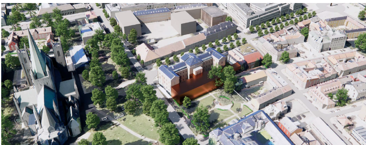
Volum i 2 etg. påkoblet Rådhuset, med gårdsrom og mulig bro over til NKIM, ca 3600m 2 BTA
