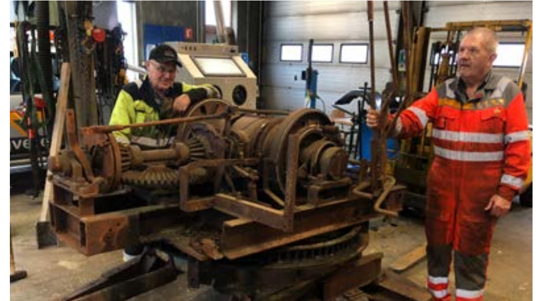
Martin Nødland og Per Skårland arbeider med å få løsnet svingkransen. (Foto: Bjørn Christian Grassdal)
