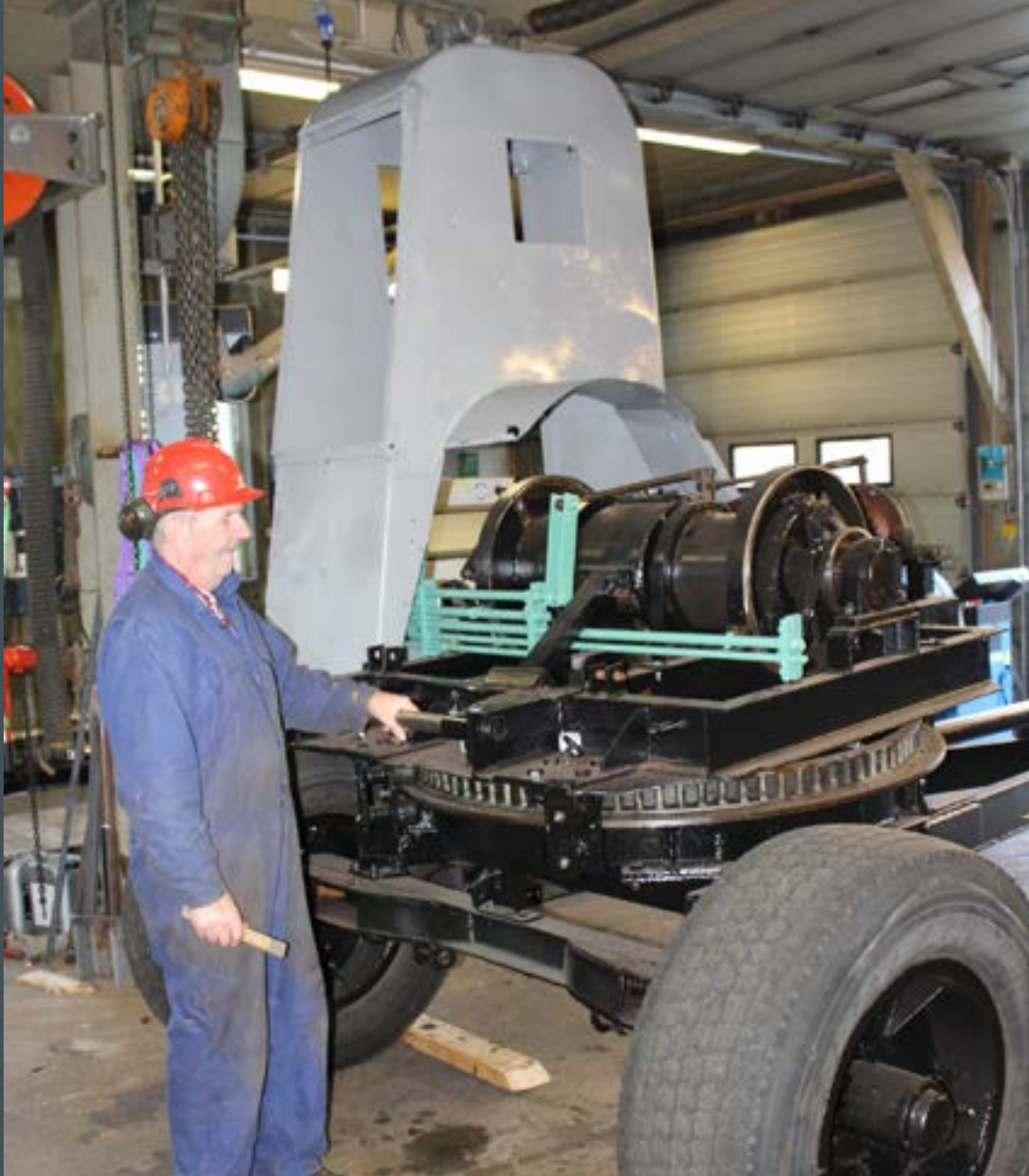
Over to år har Vegvesenpensjonisten Per Skårland ledet arbeidet med restaurering av en Brøyt 4K vaiergravemaskin fra 1954, dvs fra før hydraulikken overtok. Her er en restaurert førerhytte under tilbakemontering. (Foto: Bjørn Christian Grassdal)
