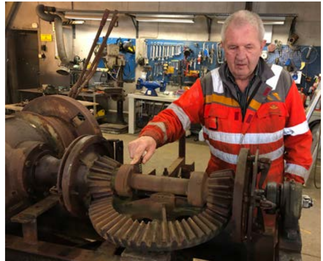
Per Skårland viser systemet for å svinge maskinen, to kløtsjer og støpte tannhjul for drift av svingfunksjonen. (Foto: Bjørn Christian Grassdal)
