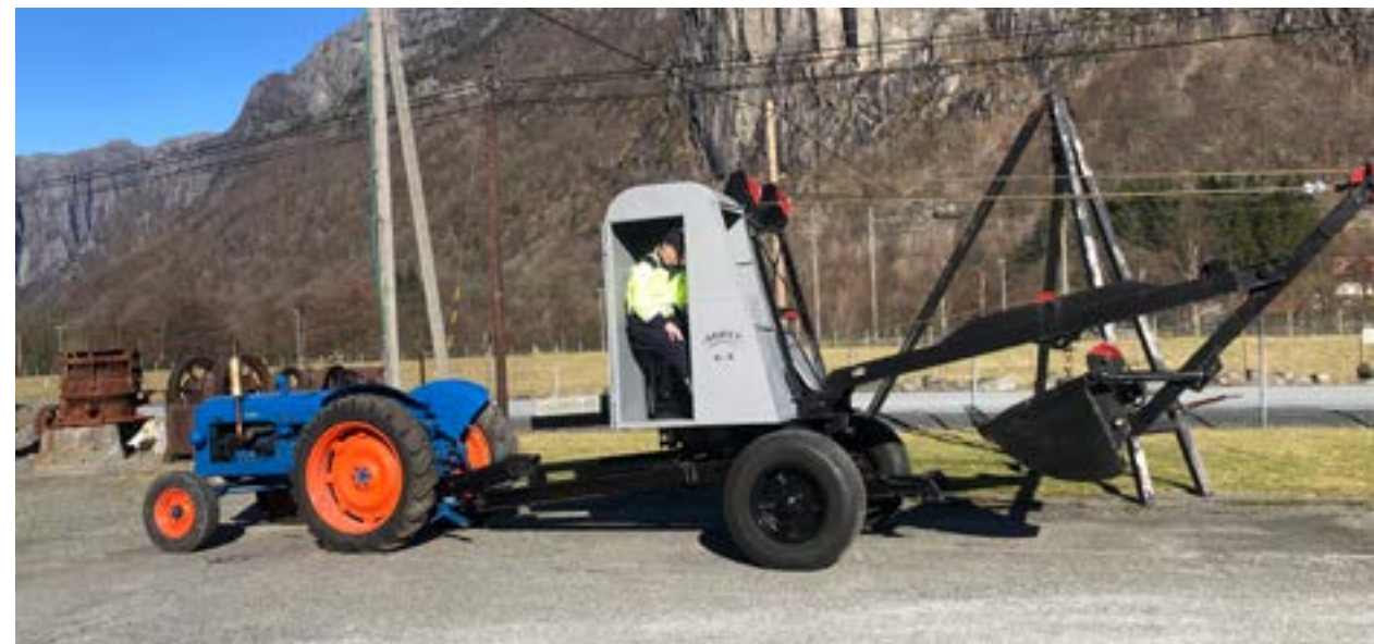
Brøyt 4K er ferdig restaurert og koblet til Fordson Major (1956) traktor. (Foto: Bjørn Christian Grassdal)
