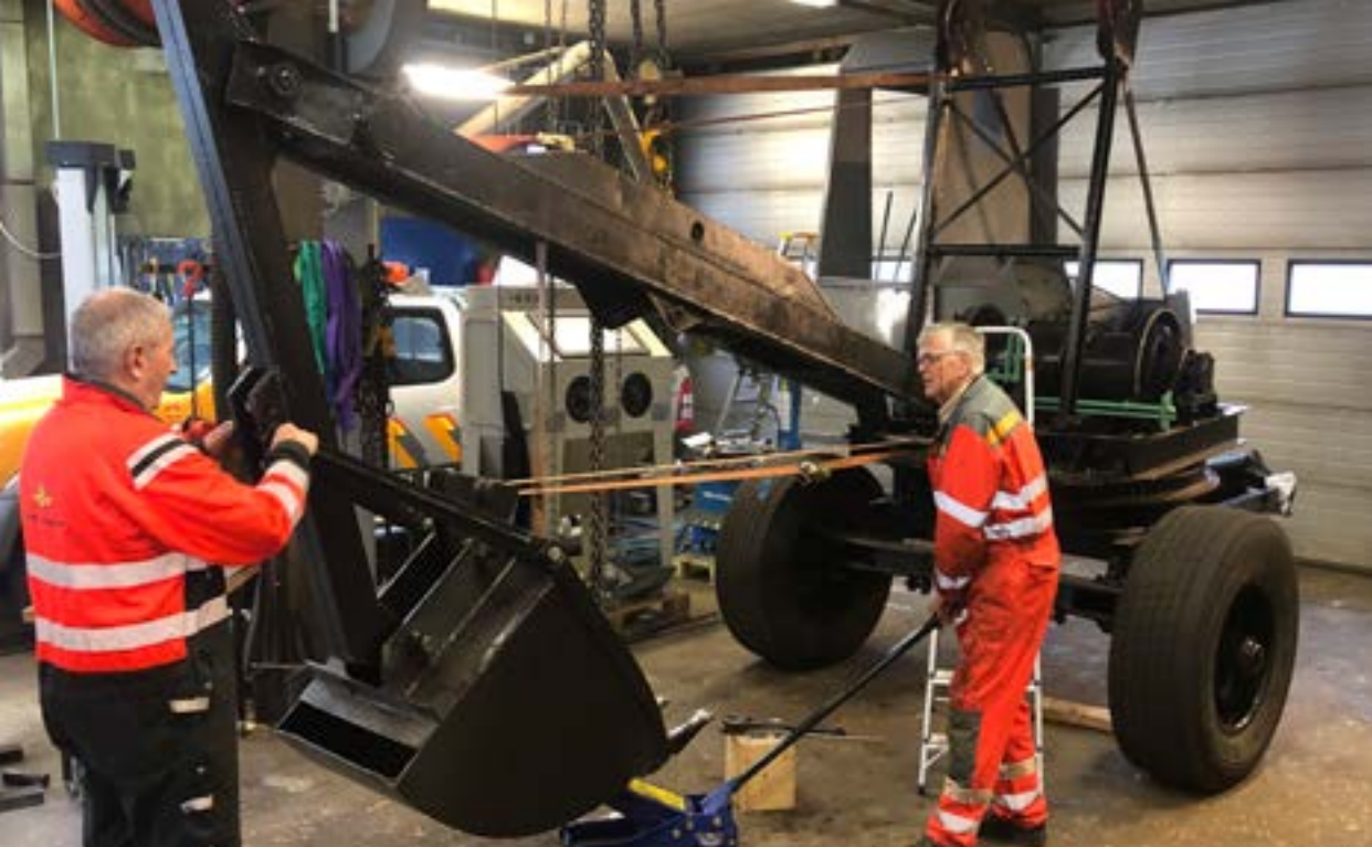
Per Skårland (til venstre) og Kjell Navrestad (til høyre) monterer graveskuffen. (Foto: Bjørn Christian Grassdal)
