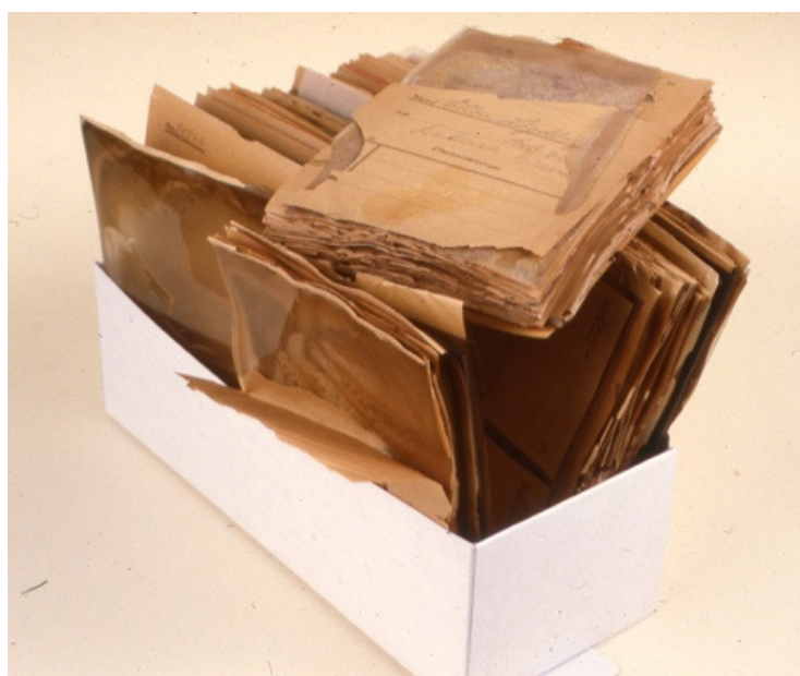
Bild 32. Sammanklibbade nedbrutna nitratnegativ.
