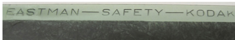
Bild 33. Exempel på märkning av acetatfilm med "safety". Oftast angavs tillverkarens namn tillsammans med "safety" eller "safety film". Märkningen är alltid i kanten utanför bildytan.
