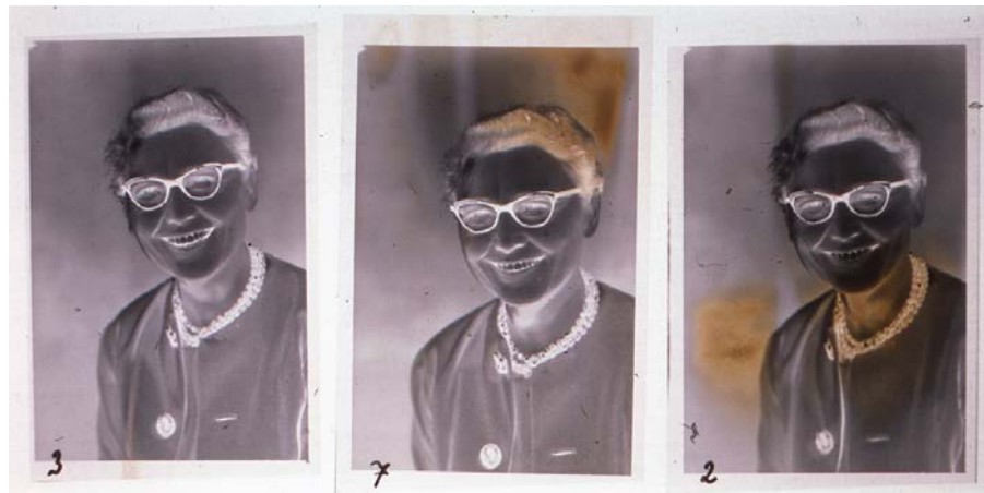
Bild 29. Nitratnegativ i tre nedbrytningsstadier – negativen är tagna samtidigt och har varit förvarade tillsammans.
