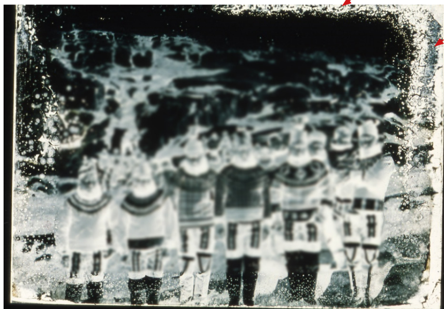
Blid 27. Silvergelinglasnegativ med spår efter mögelangrepp (se pilar) där emulsionen delvis lösts upp – gelatinemulsion som utsätts för mögelangrepp förlorar sin hållbarhet i fukt eller väta.
